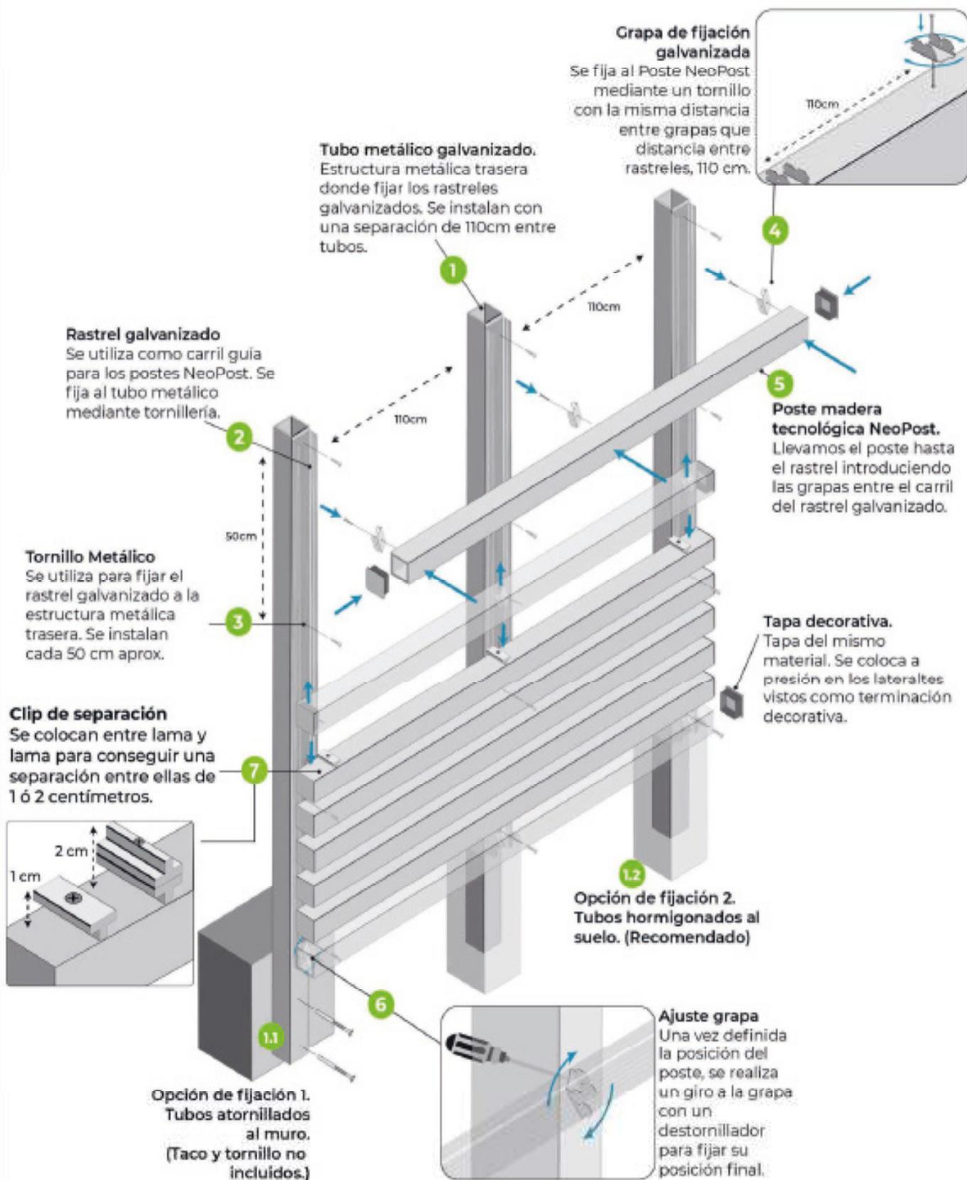
**(Sistema de montaje mediante módulos)**
