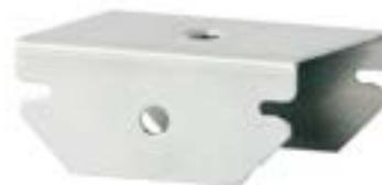
Elaborado en fleje de acero galvanizado S280 GD + Z140 (mínimo), espesor 0,9mm, se-gún la norma UNE-EN 13964:2006/A1:2008 -Techos suspendidos. Requisitos y métodos de ensayo.
