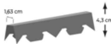
Perfil de acero galvanizado sometido a un proceso de laminación en frío para su conformado.
